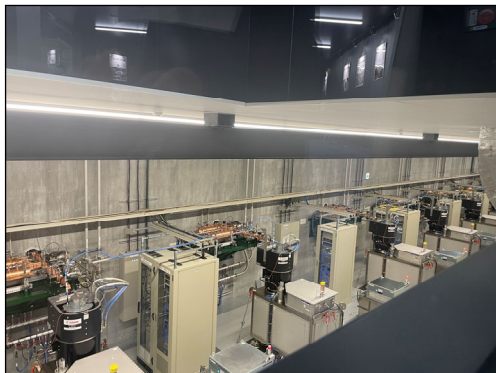
写真 4-1 電子を加速させる線形加速器
