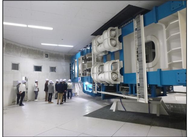
写真3-2 大型動的遠心力载荷試験装置
