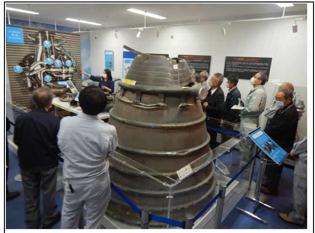
写真 3-1 海底より回収されたメインエンジン
